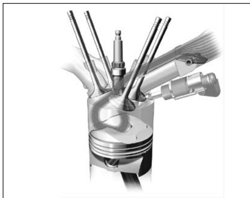
Σχ. 12. Μία πεταλούδα στην πολλαπλή εισαγωγή ελέγχει τον τρόπο εισαγωγής του αέρα για καλύτερο στροβιλισμό.
