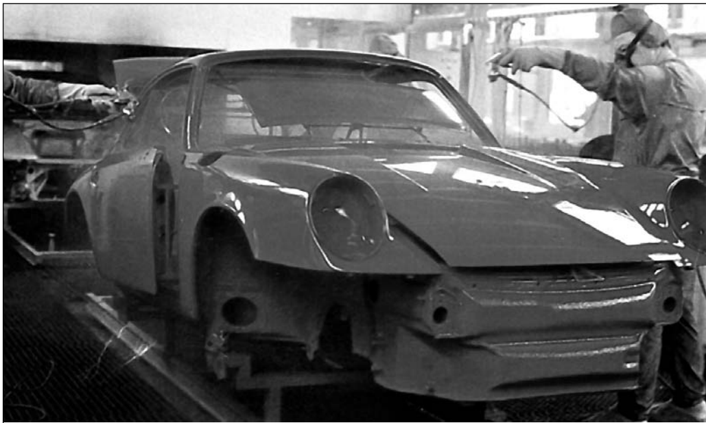
Σχ. 3.3. Βαφή αυτοκινήτου σε γραμμή παραγωγής.
