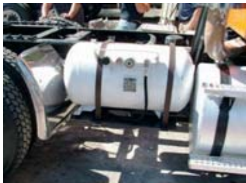
Λεπτομερής θέση τοποθέτησης δεξαμενής LPG
