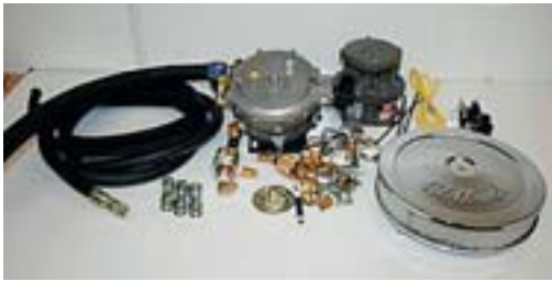
Kit συστήματος IMPCO μεταθλιτό venturi 2ns γενιάς με μείκτη-καρμπυρατέρ
